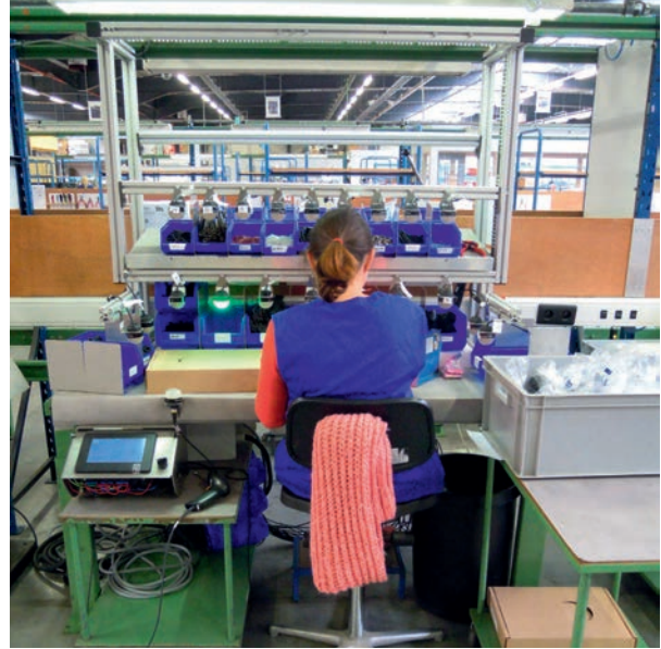
Afbeelding 11. Flexibele werkpostorganisatie met een pick-to-light systeem
