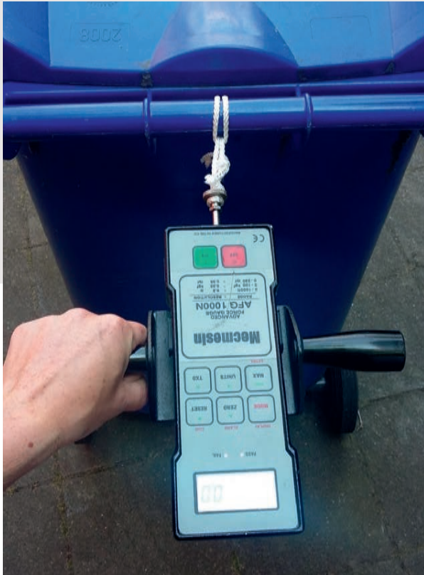
Afbeelding 1. De hand krachtopnemer bevestigd aan een container met een kort touwtje.
