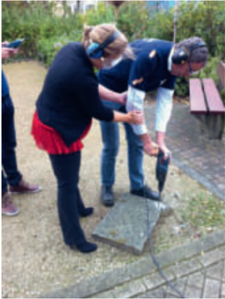
Afbeelding 1. Subjectieve beoordeling van trillingssterkte bij het gebruik van gereedschap (hamerboren in een grindtegel)
