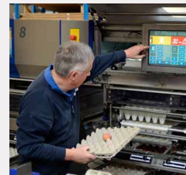
Afbeelding 4. Storing is herkenbaar door signaalkleur
