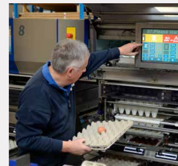
Afbeelding 4. Storing is herkenbaar door signaalkleur
