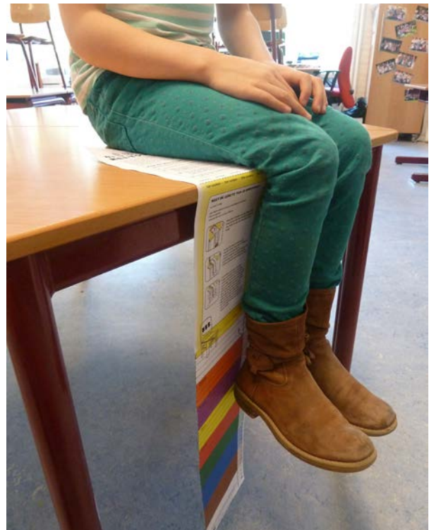
Afbeelding 2. Meten van de onderbeenlengte en aanmeten van schoolmeubilair met behulp van de aangepaste Peter de Onderbeenmeter.
