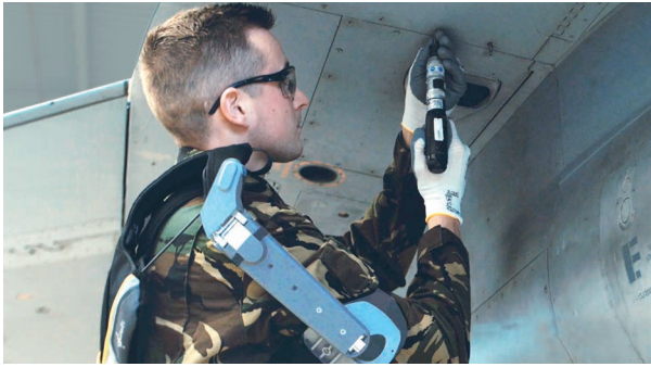
Afbeelding 1. Skelex toegepast bij bovenhandse werkzaamheden ( http://www.skelex.com/ ).
