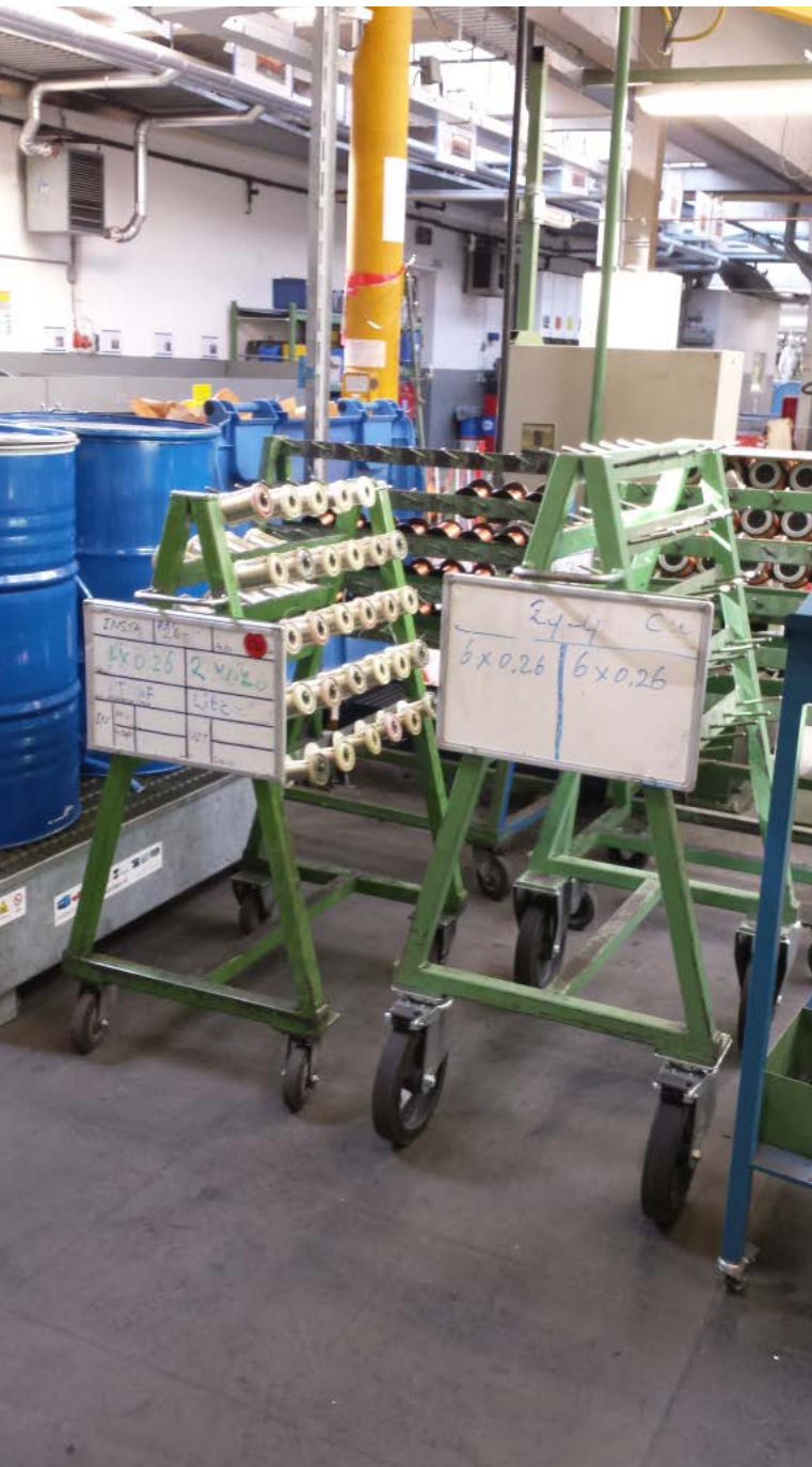
Afbeelding 5. Ter verbetering van de werkhouding is de spoelenkar aangepast, door plaatsing van grotere wielen en remmen.
