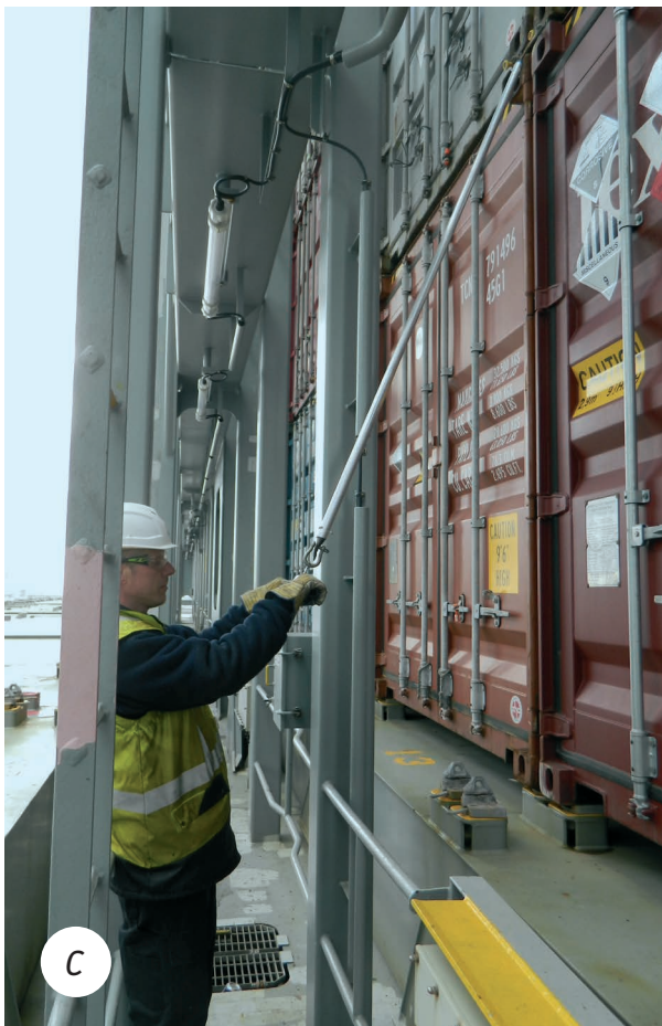
Afbeelding 2. Typische houding bij het sjorren: A. met een lange stok; B. met een korte stok; C. metingen van de krachtoefening bij lostrekken van de twistlocks.
