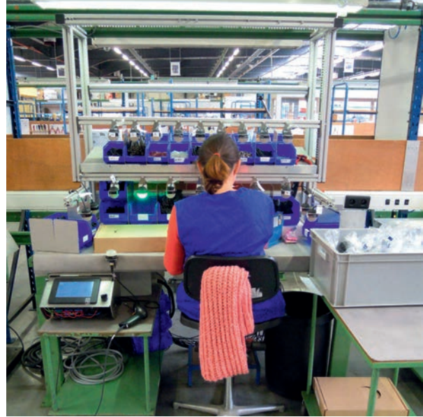
Afbeelding 11. Flexibele werkpostorganisatie met een pick-to-light systeem
