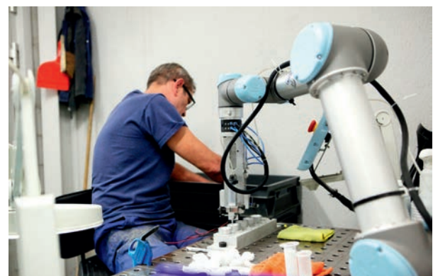
Afbeelding 2 De cobot als helpende hand bij het uitvoeren van de taak
