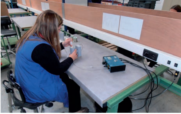
Afbeelding 7 het verlijmen van glaasjes op verlichtingsarmaturen
