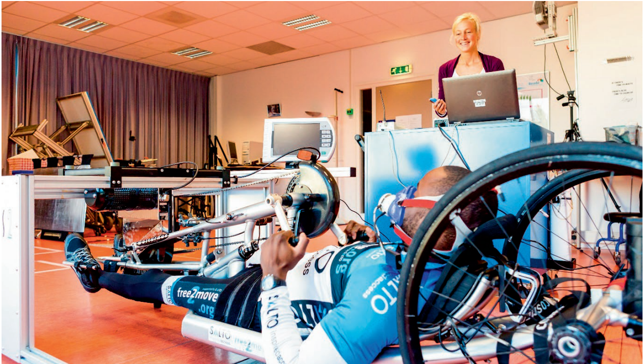
Afbeelding 3. Inspanningstest in de eigen handbike met behulp van een ergometer.
