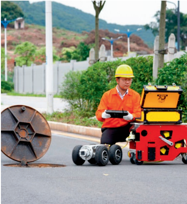
Afbeelding 2. De Schroder s300 riool CCTV pijpspectierobot.
