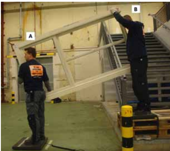
Afbeelding 1. Tillen kozijn 50 kg van afstapje
