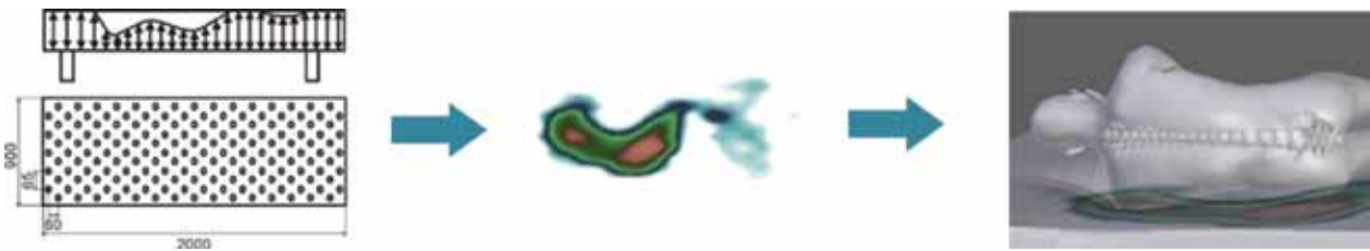
Afbeelding 3. Meetprincipe van matrasindrukking (links) en een voorbeeld van een indrukingsmeting voor een persoon in zijligging (midden) waaruit de slaaphouding herkend kan worden. Rood visualiseert een grote matrasindrukking (bijvoorbeeld ter hoogte van schouders en heup), terwijl blauw een kleinere gemeten indrukking weergeeft. Combinatie van deze indrukkinginformatie met een gepersonaliseerd 3D-model levert informatie over de vorm van de ruggenwervel (rechts) en geeft feedback over een al dan niet goede ondersteuning
