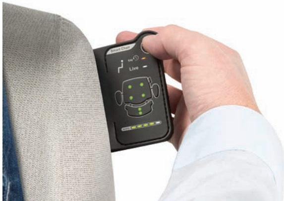
Afbeelding 2. Label voor visuele feedback over zithoudingen (functioneel studiemodel)
